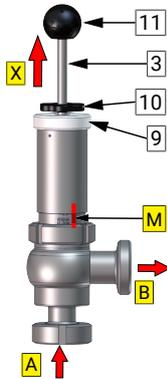
Die Handanlüftung dient zur manuellen Betätigung des Ventiles.
