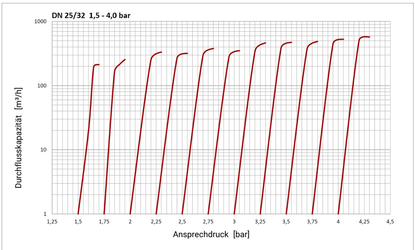
Spundventil DN15/25 | DN25/32 | DN40/50 Ansprechdruck: 1,50 - 4,00 bar (Luft 20°C)
